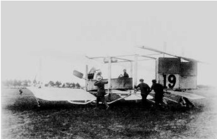
*Breguet I (moteur Renault) à Bétheny (au centre et ci-dessus). Le plan supérieur de voilure, démonté ici, est à calage ou incidence variable. (Musée de l'Air).*
