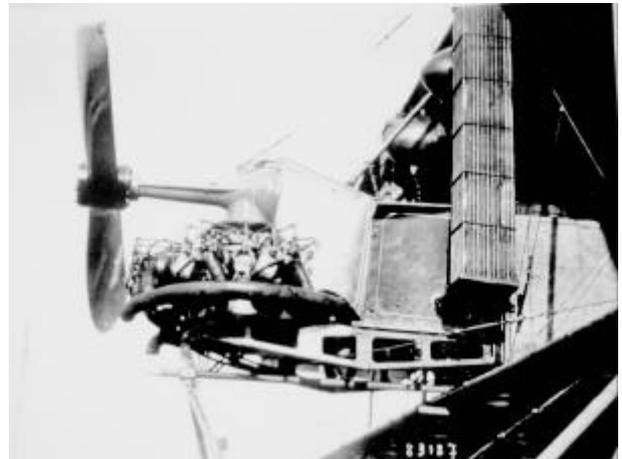
**Moteur en étoile fixe refroidi par eau construit à Billancourt par Salmson développant 180 ch. Il est disposé horizontalement et actionne l'hélice au moyen d'un renvoi d'angle.** (Cliché Musée de l'Air).
