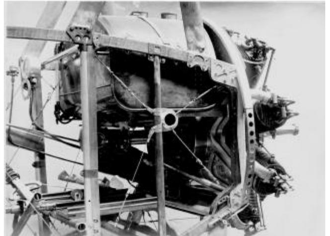
*Montage d'un moteur Clerget 9A de 110 ch sur un prototype Nieuport type 10, octobre 1914. (Collection Clerget).*
