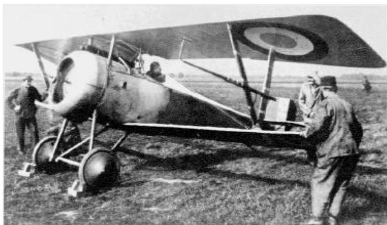
Fig. 49 - Nieuport 17 français. La mitrailleuse d'aile du Nieuport 11 a fait place à une mitrailleuse de capot, synchronisée. L'appareil photographié porte des lance fusées Le Prieur. (Musée de l'Air).
