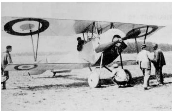
Fig. 43 - Biplan typique de 1914, le Nieuport type 10 volait à 140 km/h avec un moteur Le Rhône 9C de 80 ch. (Musée de l'Air).
