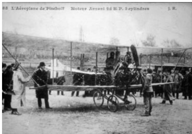
Appareil de Pischoff, moteur 3-cyl Anzani de 25 ch, 1909.
