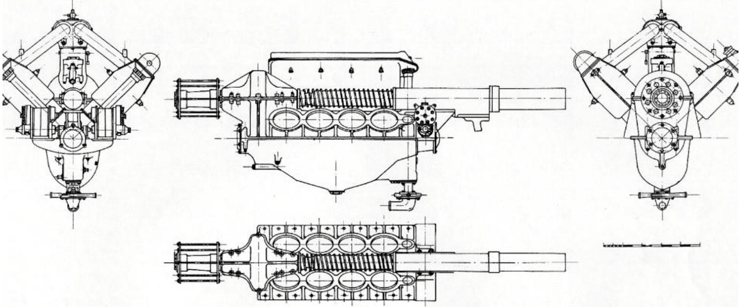
*Moteur Hispano-Suiza type 45 montrant la disposition du canon de 37 mm au centre du V.*
