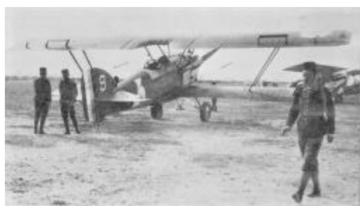
Potez 25 à moteur Lorraine 12 Eb de 450 ch.
