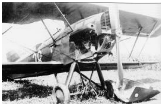
Moteur Lorraine-Dietrich 12 Eb de 450 ch équipant un Potez 25 yougoslave en 1933.
