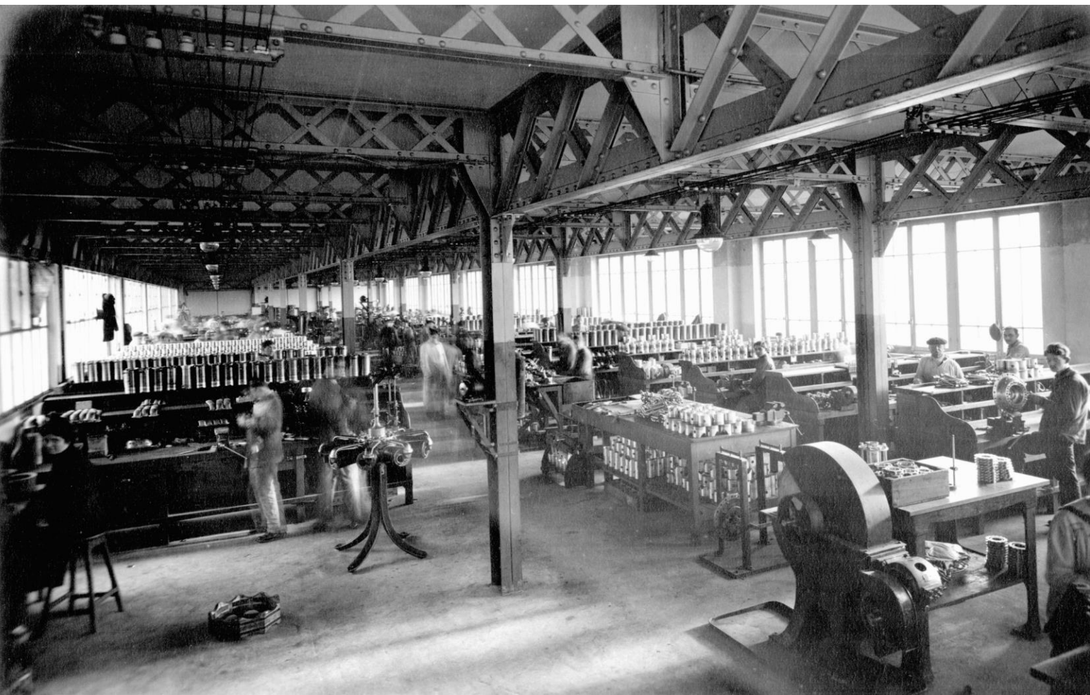
L'usine Clerget-Blin de Levallois en 1918 ne produit que des moteurs d'avion. Atelier d'alésage des cylindres. (Coll. Clerget).
