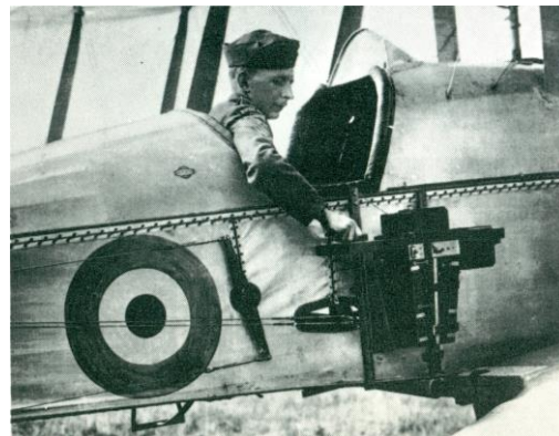
Appareil photographique monté sur appareil britannique RAF BE2C, 1916. (IWM).
