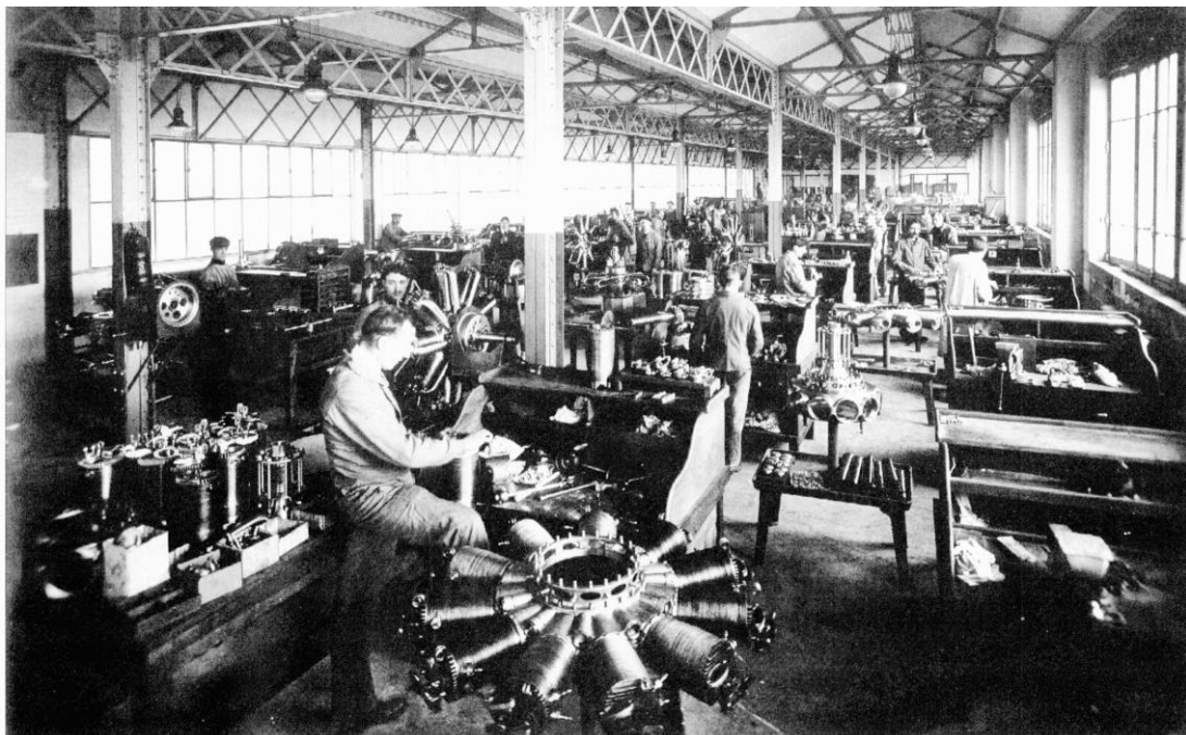
L'usine Clerget-Blin de Levallois en 1916. Elle produit des 9-cyl rotatifs de 130 ch en grande série. (Musée de Biscarrosse).
