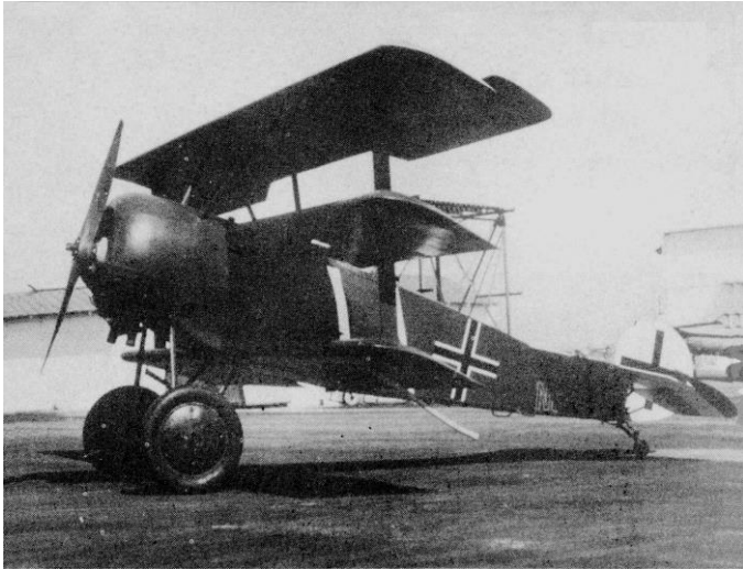
Le Fokker triplan , produit à 320 exemplaires entre mai 1917 et mai 1918, illustre la faillite du système industriel allemand : moteur dépassé, armement trop faible, performances limitées. (MAE).
