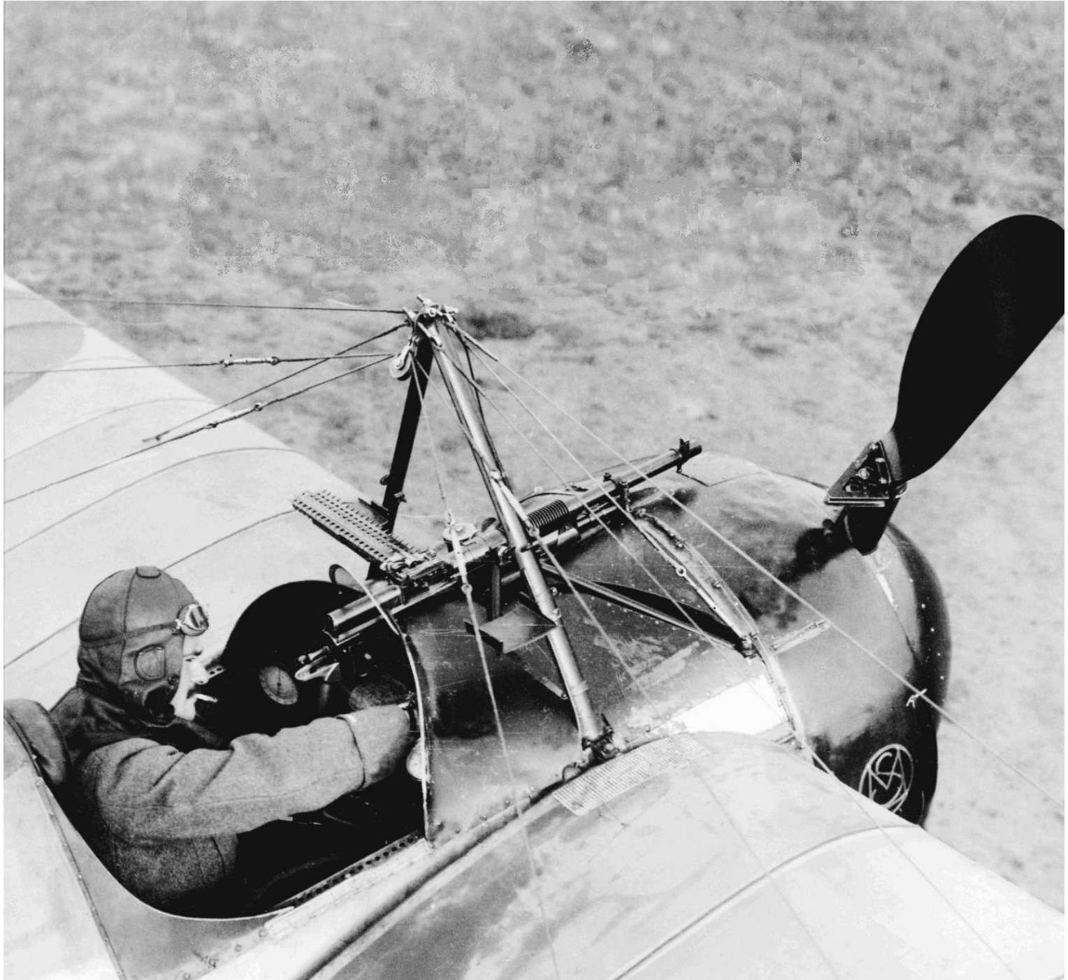
Jules Védrines réceptionnant pour l'Armée à Villacoublay un Morane-Saulnier type N, début 1915. Notez la mitrailleuse de capot et le dispositif écartant les balles des pales. C'est avec ce dispositif que Roland Garros obtient trois victoires aériennes à la MS 26 début 1915. (MAE)
