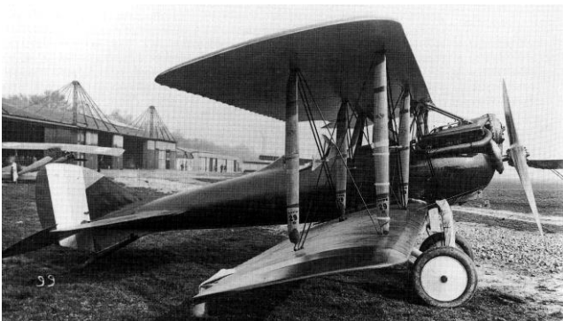
L'un des prototypes du NiD-29 C1 doté d'un turbocompresseur Rateau. (Catalogue constructeur).
