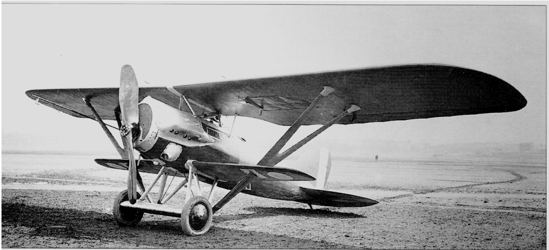
Le NiD-44, un NiD-42 C1 à moteur Lorraine-Dietrich en W, le 12 Eb de 450/500 ch sans réducteur. (Collection L. Rosenthal).
