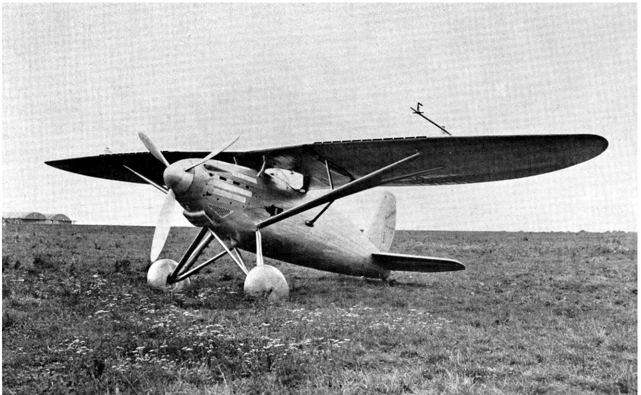
Le monoplace de chasse Nieuport-122, fin 1932. Notez la position des radiateurs, dans la section du bord d'attaque de l'aile. (Collection L. Rosenthal).
