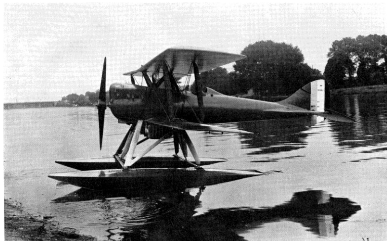
Le NiD-29 V à flotteurs de la Coupe Schneider 1921 aux essais sur le Seine à Argenteuil où il est préparé. Vitesse maximale : 290 km/h, masse au décollage : 1220 kg. (Catalogue constructeur).
