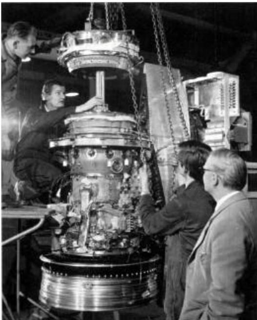
Le moteur M-45 H est un bon exemple de réacteur modulaire, facilitant les opérations e maintenance. (Snecma Moteurs).
